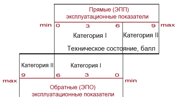
Рисунок 1 – Метод диагностирования технического состояния тракторов сельскохозяйственного назначения в полевых условиях [1]
