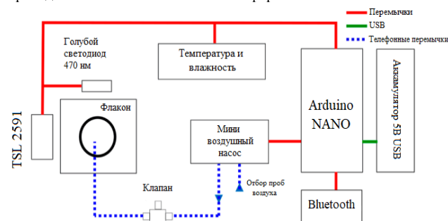
Рисунок 1. Принципиальная схема аналитической платформы для измерения концентраций сероводорода в воздухе.
